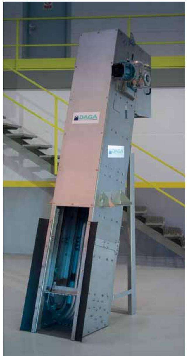
La reja de limpieza automática es un equipo monobloc diseñado para ser instalado en canales y extraer de forma automática los sólidos del agua mediante un desbaste. Este modelo N (gama media) es útil para canales de hasta 2m de anchura, una altura del agua de 9m y con una carga de elevación de 400Kg.
